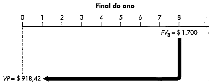
Linha de tempo do valor presente de uma quantia individual (quantia futura de $ 1.700, descontada a 8%, a partir do final de oito anos)
